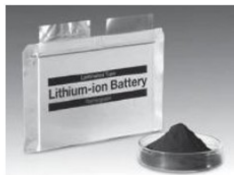
図6 高性能Liイオン電池を支えるカーボン負極材
